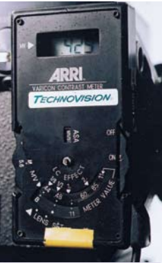
Télécommande de calcul du contraste Varicon
