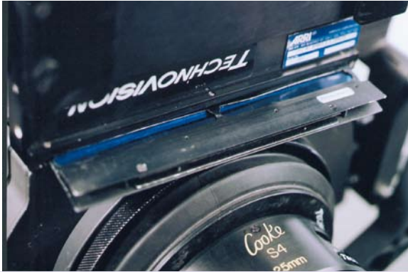
Porte-film gélatine sur le Varicon
